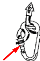
Mosquetó amb tanca de rosca i nus dinàmic mal col.locat. El lliscament de la corda el podria arribar a obrir...
