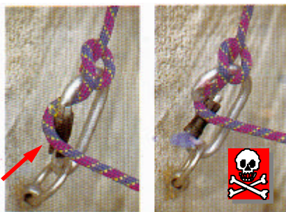
Mosquetó amb tanca de rosca i nus dinàmic mal col.locat. El lliscament de la corda el podria arribar a obrir...
